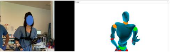
Annexe 11a : Exemple d'un avatar créé avec le logiciel CAPTIV, pour analyse des angulations articulaires
